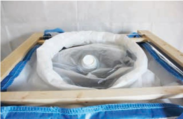
Verschlossene Innenfolie nach der Befüllung. Anschließend erfolgt das Verschließen des Gewebe-Einfüllstutzens.
